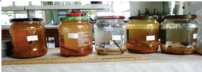
Рис. 1 Банки с образцами (1-5 слева направо). Снимок сделан по окончании последней экспозиции (7150 часов)
