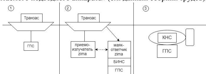
Рисунок 1 – Схемы расположения датчиков при установке ГПС на надводном носителе (1), на ТНПА (2) и на АНПА (3).
