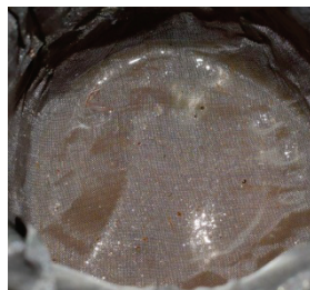
Рис. 2 – Образец пробы морской воды: съемный металлический фильтр 100 мкм.
