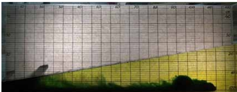
Рис. 2. Движение турбидитного потока по дну бассейна (угол наклона бассейна – 10^\circ , концентрация взвешенного вещества в суспензии – 50 \text{ г/кг} , плотность взвеси – 1,25 \text{ г/см}^3 , гидравлическая крупность частиц – 0,0029 \text{ см/с} )
