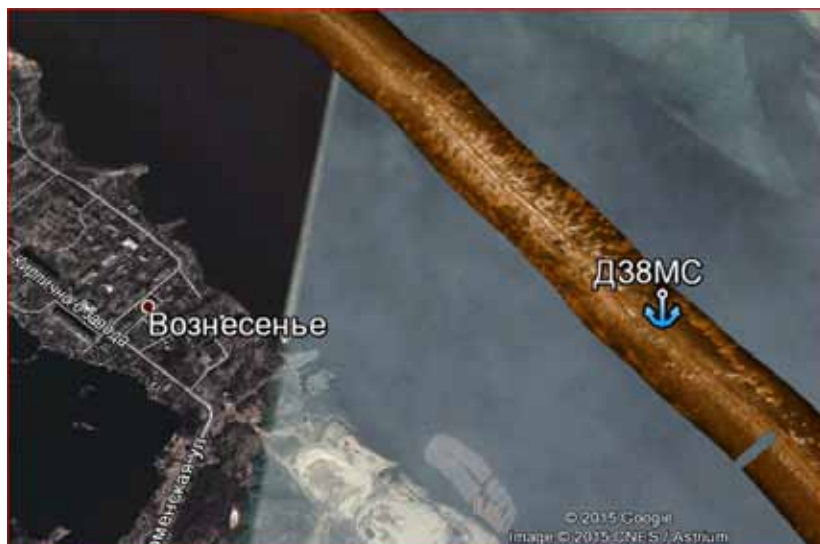
Рис. 2. Пример участка русла с гидролокационным изображением дна и точкой отбора проб донных отложений
