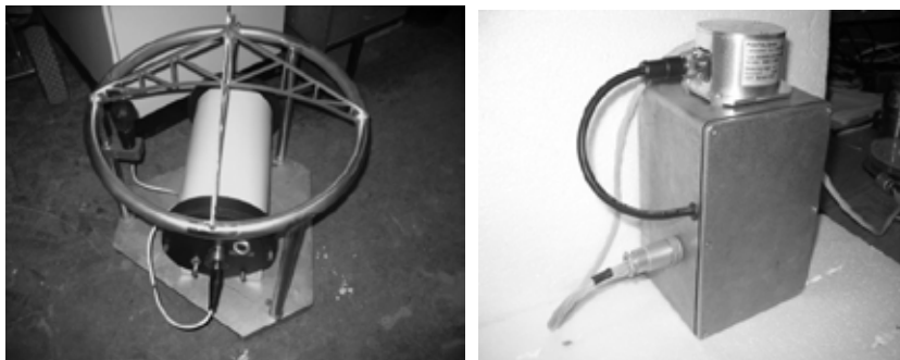
Рис. 1. Блоки сейсмографа (слева) и наклономеров и акселерометров (справа) системы сейсмологического мониторинга нефтяного месторождения им. Корчагина (разработка ИО РАН)
