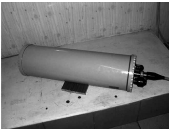
Рис. 2. Донный кабельный сейсмограф с широкой полосой регистрации (разработка ИО РАН)
