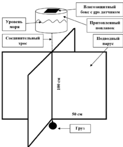
Рис. 1. Конструкция дрейфующего буя
