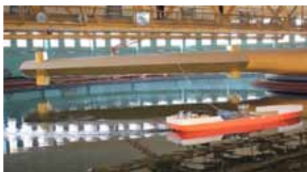
Рис. 4. Модельные испытания Многофункционального НИС в циркуляционном бассейне ФГУП «Крыловский государственный научный центр»
