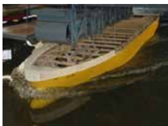
Рис. 3. Буксировочные испытания модели Изыскательского НИС в гидродинамическом бассейне ФГУП «Крыловский государственный научный центр»
