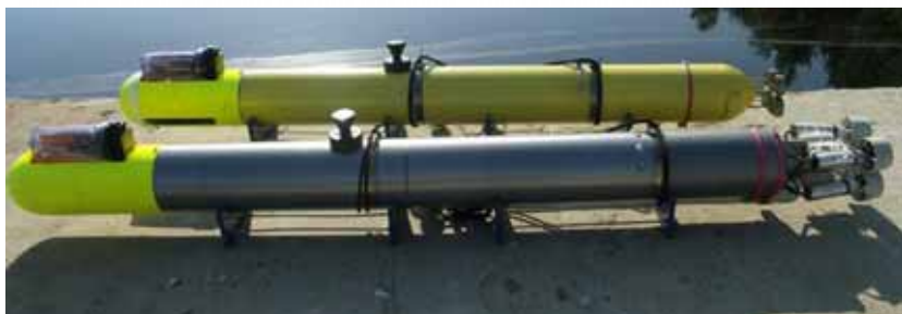
Рисунок 2 Модульная конструкция и внешний вид АНПА группового управления
