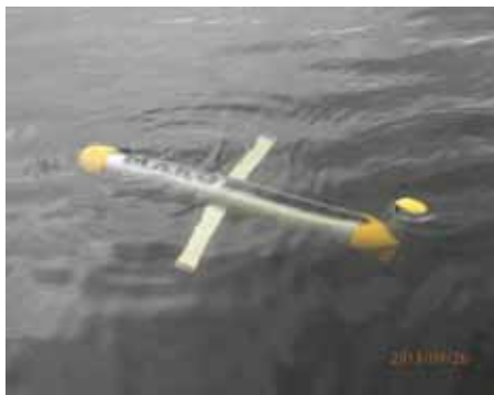
Рис. 1. Базовый архитектурно-конструктивный тип аппаратов разрабатываемого ряда – торпедообразный глайдер двухкорпусной схемы на испытаниях
