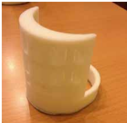
Готовое защитное ограждение сонара до извлечения поддержки
