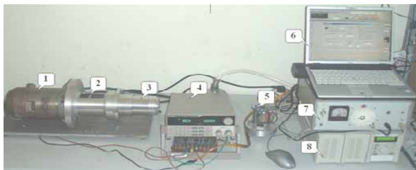
1 – нагрузочный генератор; 2 – согласующая муфта; 3 – вентильный электродвигатель в герметичном контейнере; 4 – электронная нагрузка генератора; 5 – блок управления электродвигателем; 6 – управляющий компьютер; 7 – блок электроники стенда; 8 – блок питания.
