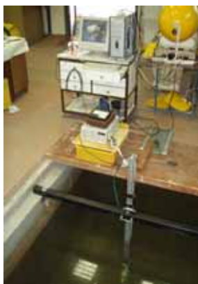
б) Движитель НПА в бассейне на измерительной тензобалке: 1 – тензометрический усилитель; 2 – тензорезисторы; 3 – компенсатор давления; 4 – движитель НПА
