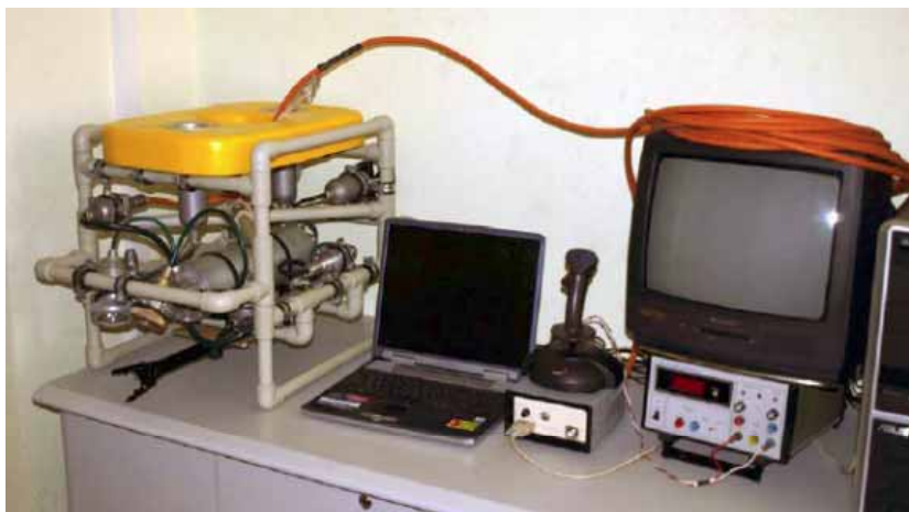
Рис. 4. Первый вариант студенческого малогабаритного привязного телеуправляемого подводного аппарата (МПТПА) «Юниор»
