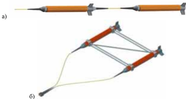
Рис. 2. Внешний вид магнитометров градиентометров: курсового (а) и траверзного (б)
