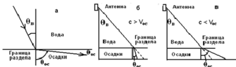
Рис. 2. Преломление звука при падении на границу «вода-осадки»
