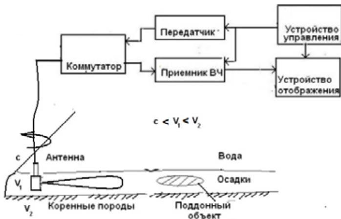
Рис. 2. Схема, поясняющая предлагаемый подход к зондированию поддонных объектов
