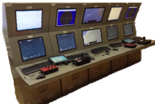
Рис. 1. Тренажерный комплекс для обучения операторов телеуправляемых необитаемых подводных аппаратов различных типов
