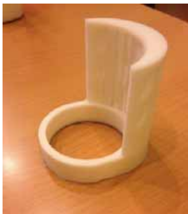
Готовое защитное ограждение сонара до извлечения поддержки
