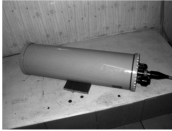
Рис. 2. Внешний вид кабельной донной сейсмостанции КДСС-1 на постаменте в испытательном бункере ОКБ ОТ РАН
