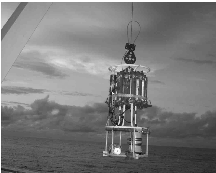
Рис. 2. STD-зонд SBE-19-plus и погружаемый профилограф скорости LADCP Sentinel Workhorse 300 kHz вместе с пингером и батометрами на карусели SBE32
