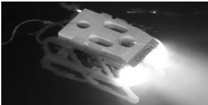
Рис. 2. Телеуправляемый необитаемый подводный аппарат класса мини «ГНОМ-супер» во время ночного погружения в районе п. Чолпон-Ата
