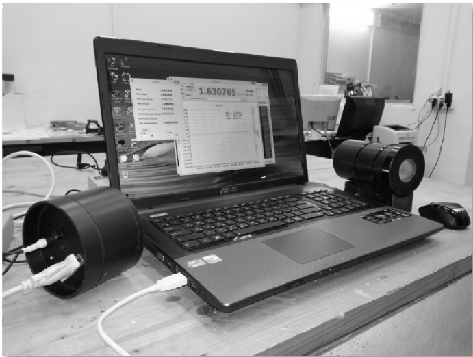
Рис. 1. Фотоприёмное устройство (слева), окно программы регистрации сигналов и вывода графика (на десктопе), автономный источник света (справа)
