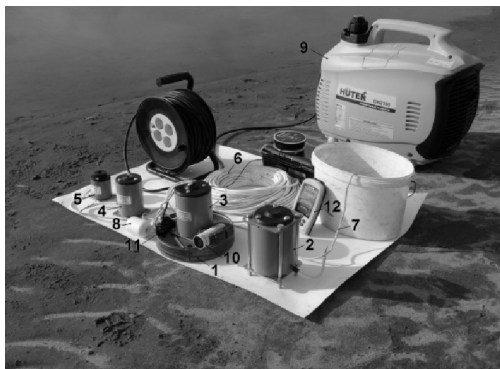
1 — электромагнитный штамп; 2 – 5 — сменные электромагниты штампа; 6 — кабель-трос; 7 — страховочный линь; 8 — стабилизатор; 9 — бензогенератор; 10 — подводная видеокамера; 11, 12 — проводная подводная видеокамера с интегрированными осветителями и ее монитор, соответственно
