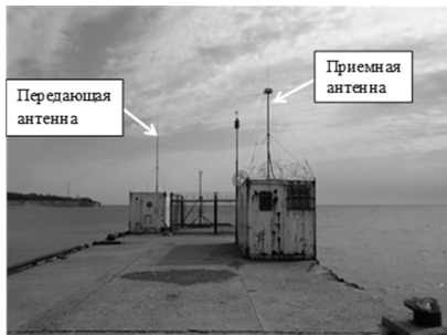
Рис. 1. Размещение передающей и приемной антенн радиолокатора Sea Sonde на крышах кунгов на пирсе ЮО ИОРАН в Голубой бухте
