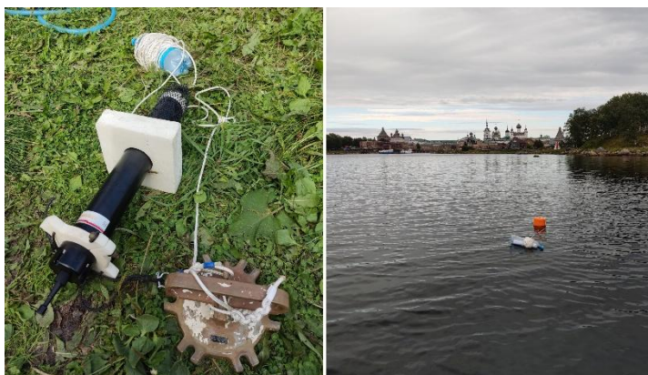
Рис. 3. Слева – прибор ADCP до установки в придонный слой бухты, справа – буй дополнительного якоря на поверхности бухты Благополучия.
