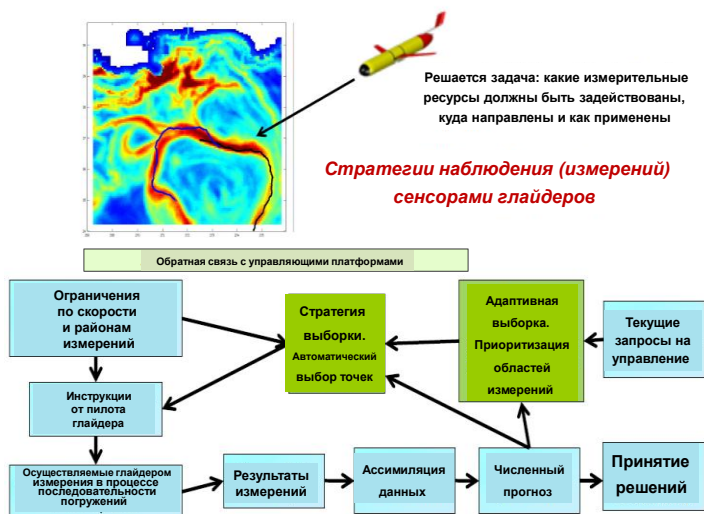
Рис. 2 Использование аппаратов-планеров для оценивания параметров океанической среды с целью уменьшения неопределенности оценок [4].
