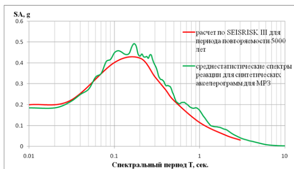
Рис. 1. Спектр реакции с 5% затуханием для периода повторяемости 5000 лет и среднестатистический спектр реакции, построенный по ансамблю из 10 синтетических акселерограмм Расчет по программе NERA (для сейсмического микрорайонирования) для разреза, разработанного до глубины 140 м в месте расположения
