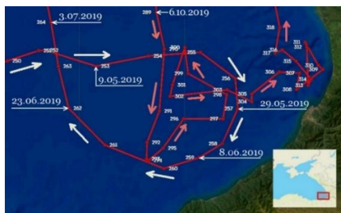
Рис. 1. Пример траектории движения профилирующего буя
