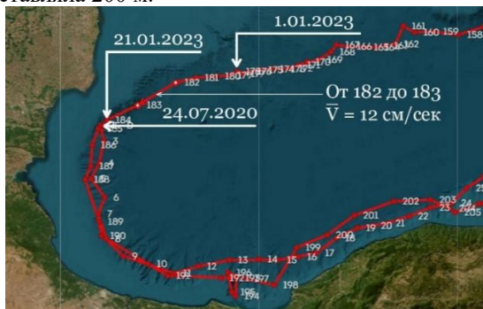
Рис. 2. Пример траектории движения профилирующего буя
