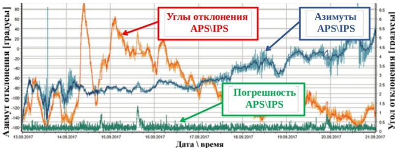
Рис.5. Углы ориентации (отклонение от вертикали и азимут) секции по APS и IPS
