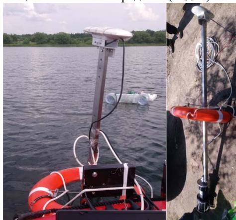
Рисунок 2 – Внешний вид буя (справа) и его размещение в акватории с лодки (слева)
