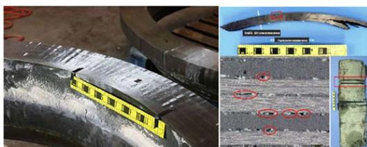
Рис. 2. Волнистость и морщины на обрезанном конце, пористость на вырезанном сегменте.
