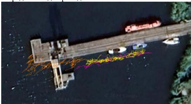
Рисунок 3 – Положение маяка-ответчика при движении вдоль пирса
