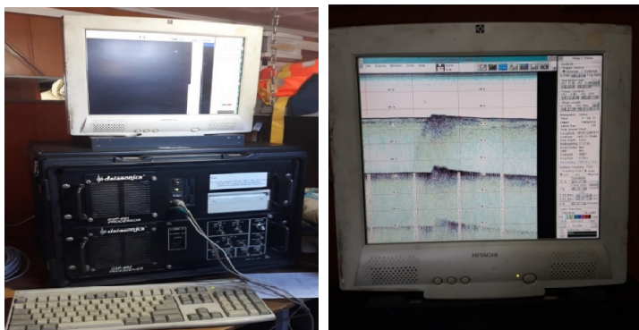
Рис. 3. Судовой блок аппаратуры акустического профилирования (слева) и пример изображения разреза рыхлых отложений
