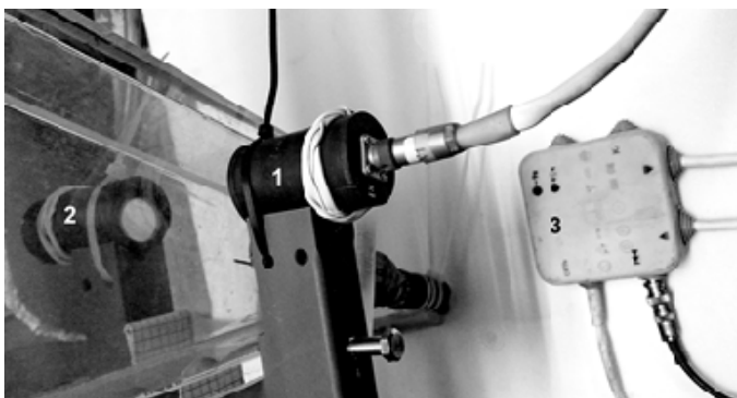
Рис. 2. Слева одна из схем лабораторной установки с прозрачномером: 1 – излучатель, 2 – приемник, 3 – пульт
