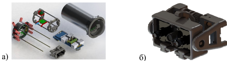
Рис. 3а – главный прочный корпус НПА «Кусто II», 3б – наклонное устройство с видеокамерами
