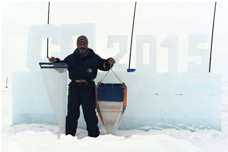
Рис. 1. Планктонный сачок (слева) и планктонный трал (справа), использовавшие при проведении сравнительного исследования для оценки состава криофауны в период работ ледовой дрейфующей станции «Северный полюс–2015»
