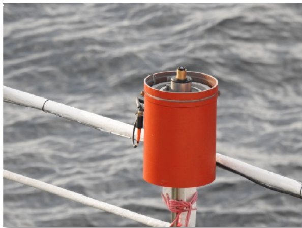
Рис. 1. Палубный датчик Li-190 в герметичном боксе со стабилизатором на палубе НИС «Академик Мстислав Келдыш»
