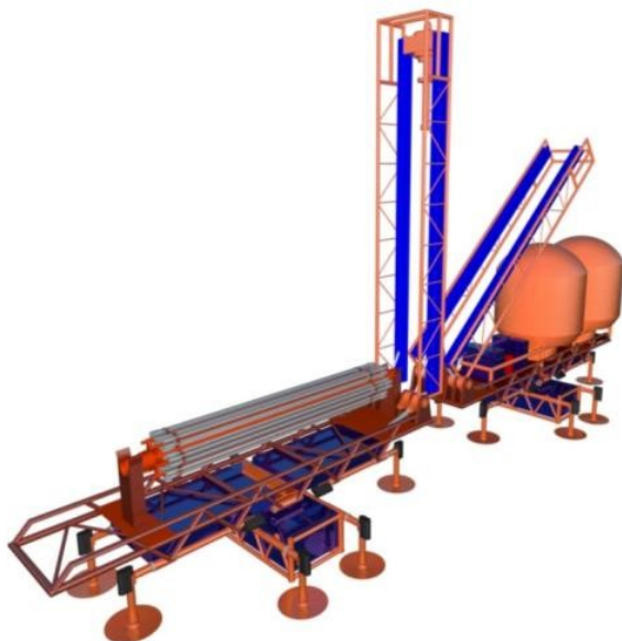
Рис.1 Подводная буровая установка на базе шагающих платформ
