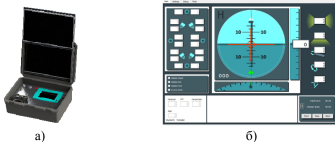
Рис. 1. Надводный модуль управления: а – ударопрочный кейс, б – интерфейс оператора
