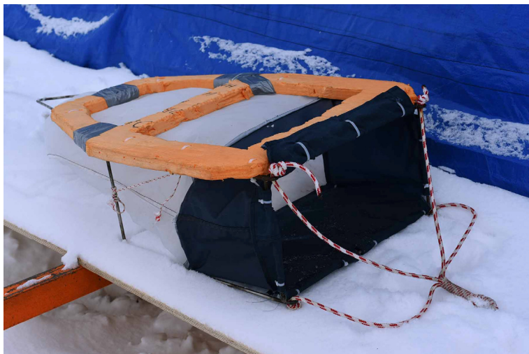
Рис. 2. Планктонный трал, использовавшийся для проведения горизонтальных ловов криофауны с нижней поверхности льда в период дрейфа станции «Северный полюс-2015» в центральном Арктическом бассейне с апреля по июль 2015 г.
