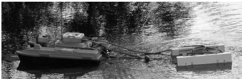
Рис. 2. Катер в снаряженном состоянии на воде, буксирующий антенну профилографа
