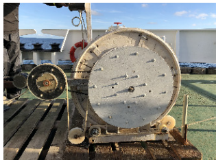
Рис. 1. Схема действия устройства с тянущим блоком (слева) и его размещение на корме судна (фото справа)
