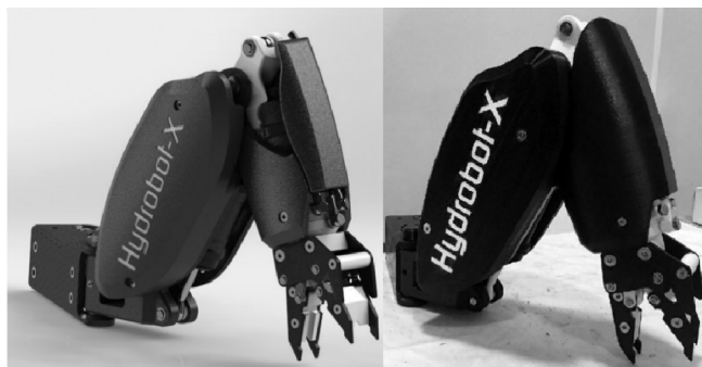
Рис. 2. 3D модель и макет разработанного манипулятора
