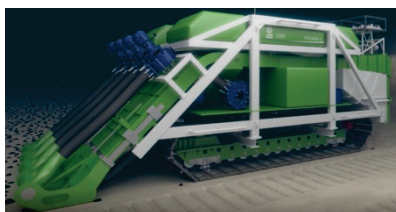
Рис. 2. НПА «Patania II» в процессе сбора конкреций
