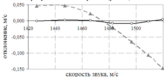
Рис. 1. Графики отклонений результатов измерений скорости звука без учета (пунктирная линия) и с учетом (сплошная линия) зависимости эффективной длины измерительной базы от скорости звука
