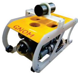
Рис. 4 Дополнительная видеокамера размещена в специальном прочном корпусе.
