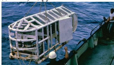
Рис.3. Глубоководный буксируемый аппарат «Ангус» (“Angus”).
