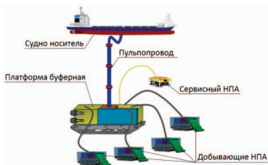
Рис. 3. Пример исполнения добывающего комплекса с группой добывающих ТНПА
