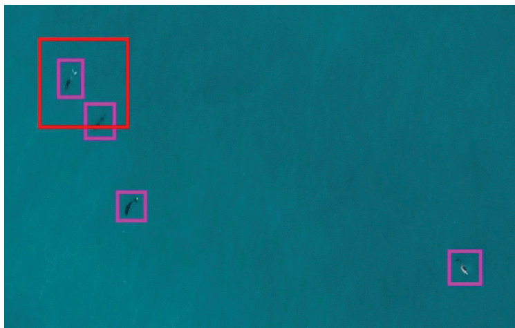
Рис. 1. Пример результата функционирования детектора аномалий. Красным квадратом отмечен патч, сочтенный аномальным; розовыми квадратами отмечены дельфины, выделенные экспертом при разметке изображений набора данных.
